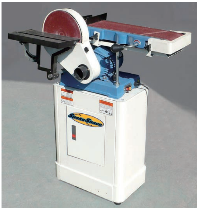
サンディングベルトは水平位置から 90° までの間の 所望の角度に設定できます。
