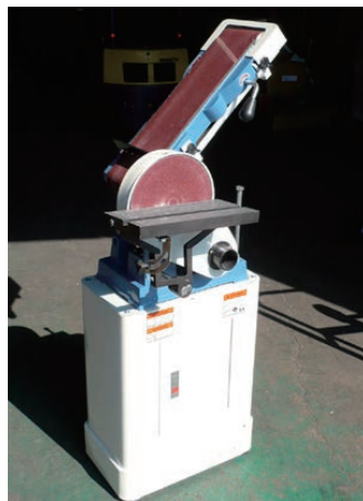
サンディングベルトは水平位置から 90° までの間の 所望の角度に設定できます。
