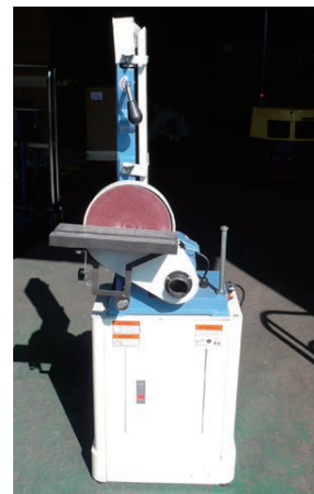
サンディングベルトは水平位置から 90° までの間の 所望の角度に設定できます。
